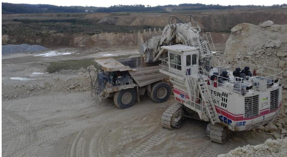
**Figure 7 : Processus d'extraction – Chargement d'un dumper 100 tonnes**
