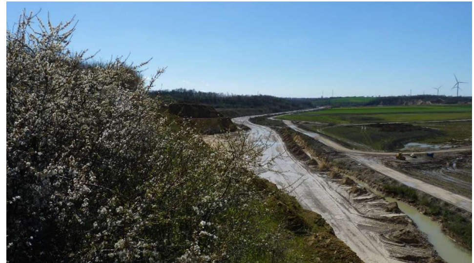
Figuur 9 : Verkeersstromen in de steengroeve: pad voor 100-tonners aan de linkerkant, en pad voor vrachtwagens van klanten en anderen aan de rechterkant
