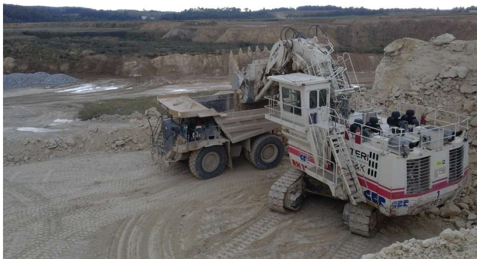
Figuur 7 : Ontginningsproces – laden van een dumper van 100 ton Bron: ARCEA
